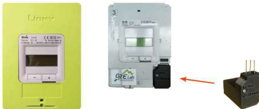
1 — Dispositif xKy à installer sur la prise en façade du compteur Linky.
